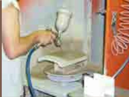
Noch heute werden Ofenkacheln für DROOFF-Kaminöfen nach traditioneller, handwerklicher Überlieferung gefertigt. Es dauert viele Tage, bis aus der flüssigen Ton- und Schamottemischung eine gebrannte Ofenkachel mit vorgegebener Form wird. Mit der Sprühpipette wird die Glasur auf den Kachelkorpus aufgetragen und bei über 1000° C eingebrannt.
